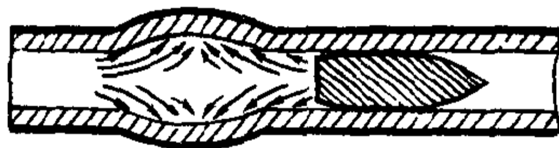
图 2-86 枪管膨胀原理图
